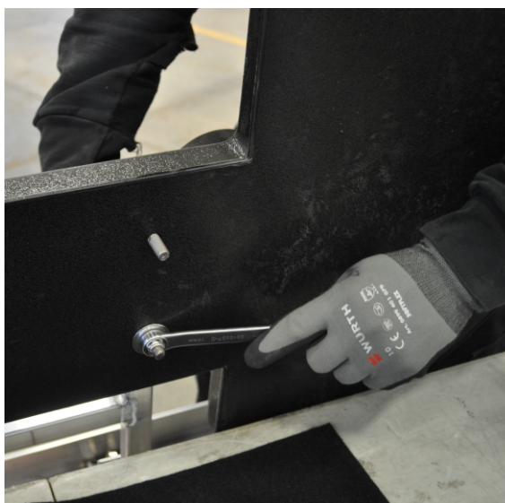
Assurez-vous de mettre une rondelle à l'avant et à l'arrière de la flèche pour chaque boulon
