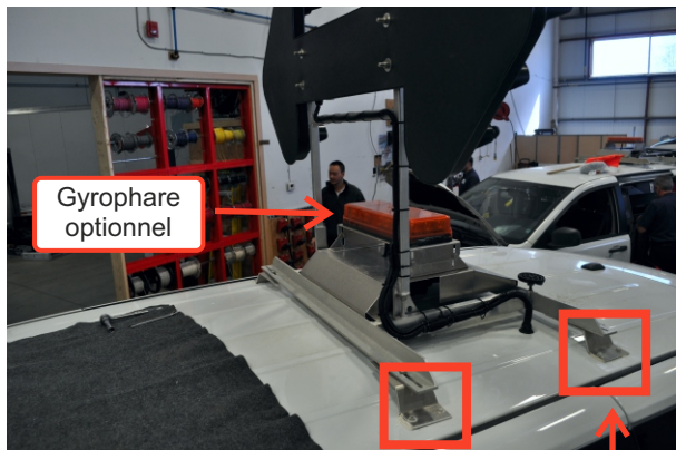
Trous à percer (2 côté du véhicule)
