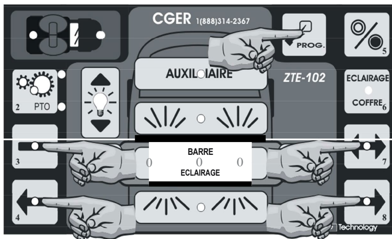
FIGURE 5 : Programmation du temps de montée et/ou de descente automatique
