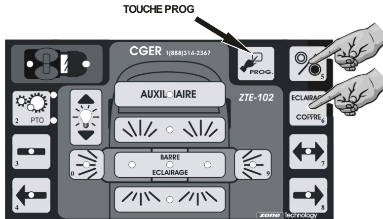
FIGURE 1 : Accès au menu « Programmation du clavier »
